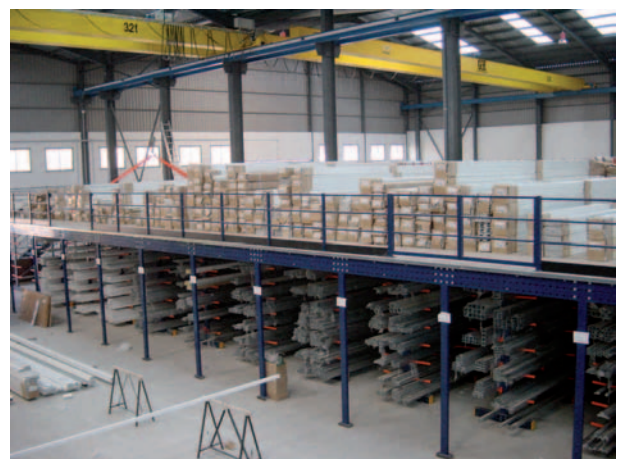
Almacén distribuidor perfiles de aluminio: entreplanta MECA con estantería cantilever integrada para la zona de preparación de pedidos. La planta superior se destina para el almacenaje en bloque.
